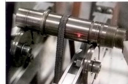
Mit einem Sensor werden Position und Drehzahl dieser Welle während des Auswuchtens überwacht
