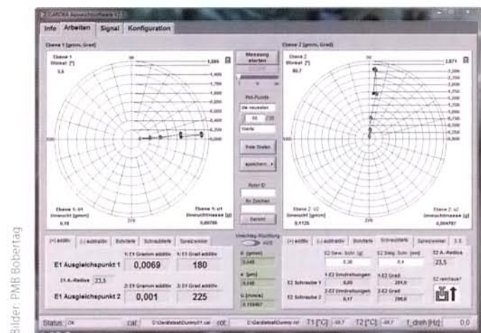
Wie auf einer Schießscheibe zeigt die Software CAROBA-soft an, wie die Unwucht eliminiert wird
