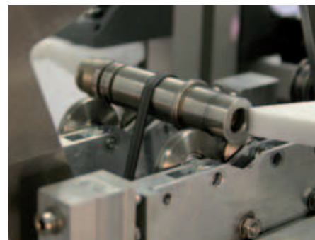
Hier wird eine kleine Getriebewelle neu gewuchtet
